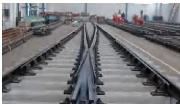
■ 时速250公里18号固定型单开道岔 250 Km/h No. 18 monoblock single turnouts
