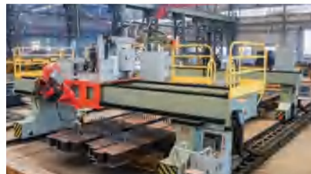
剪力钉自动焊机器人 Automatic welding robot for shear studs
