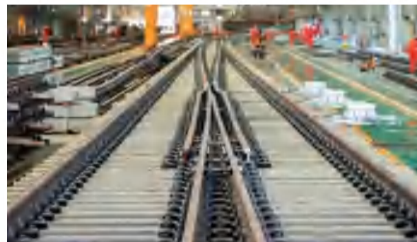
■ 时速350公里60kg/m钢轨42号可动心轨高速道岔, 道岔全长157.2米, 侧向通过时速160公里 60kg/m No.42 movable-nose high-speed turnouts, Total length:157.2m, Straight speed: 350km/h, Divergent speed:160km/h
